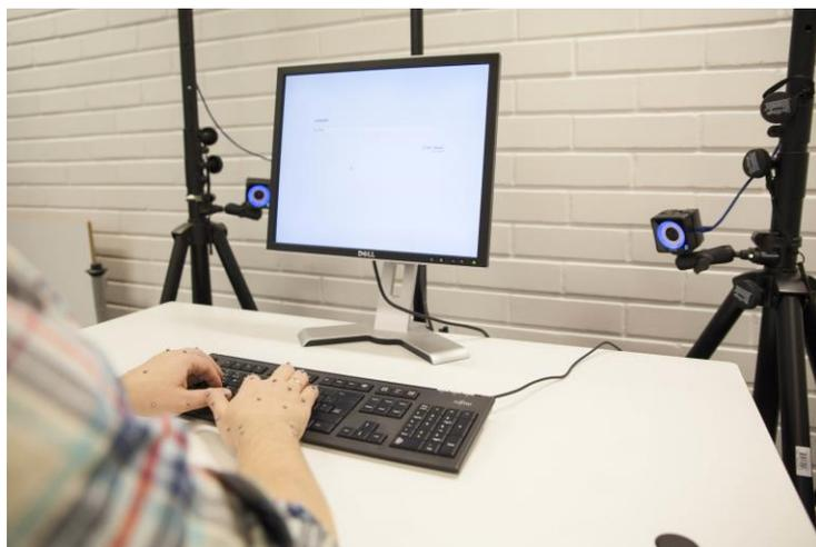
*Hochgeschwindigkeitskameras nehmen die genaue Position der Hände und Finger beim Tippen auf. Zusätzlich zeigt eine Eyetracking Brille, ob der Teilnehmer auf den Bildschirm oder die Tastatur schaut.*
